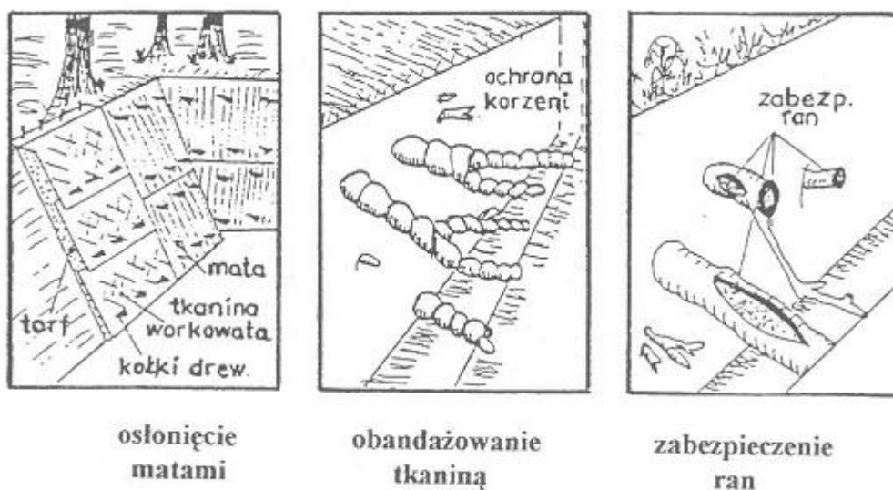
Rys. 6. Zabezpieczenie korzeni (rys. pochodzi z "Chirurgia drzew" Z. Chachulski).
