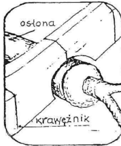
Rys. 7. Zabezpieczenie korzeni przy układaniu krawężników (rys. pochodzi z "Chirurgia drzew" Z. Chachulski).
